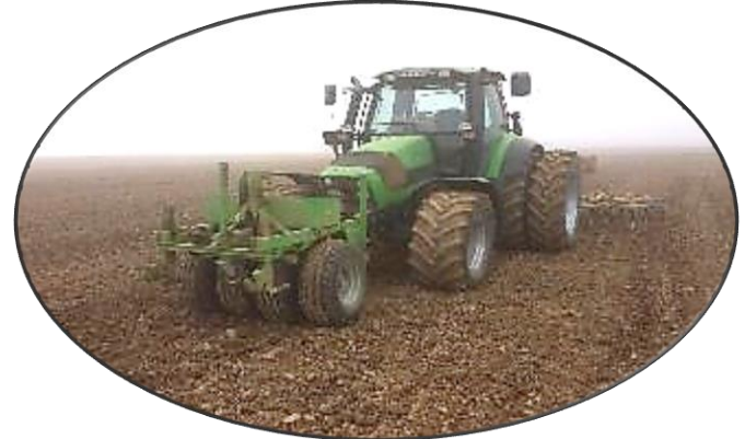
Flachgrubber mit Doppelstriegel, Schlepper mit Zwillingsbereifung und Frontreifenpacker
