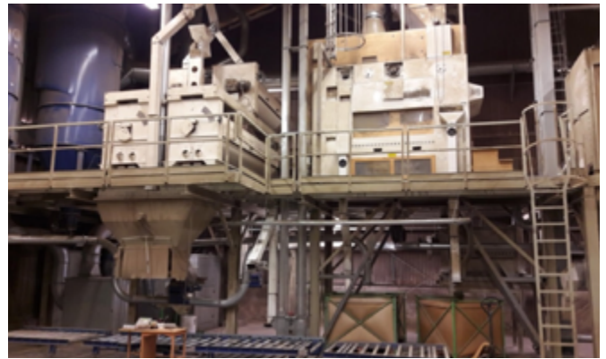
Reinigungsanlage der ZG Raiffeisen eG in Hüfingen; links die Trieure und rechts die Sieb- und Aspirationsanlage Foto: Götz Lechler/ZG
