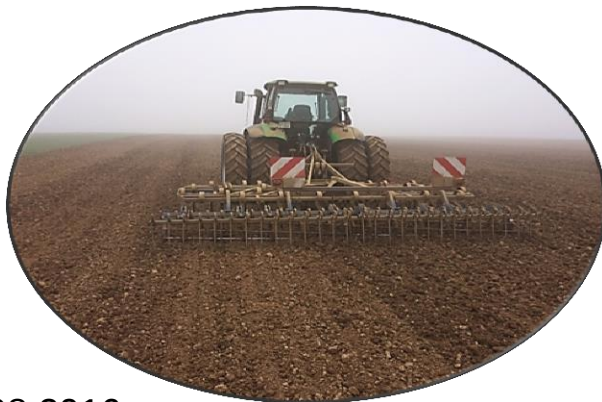
Flachgrubber mit Doppelstriegel, Schlepper mit Zwillingsbereifung und Frontreifenpacker
