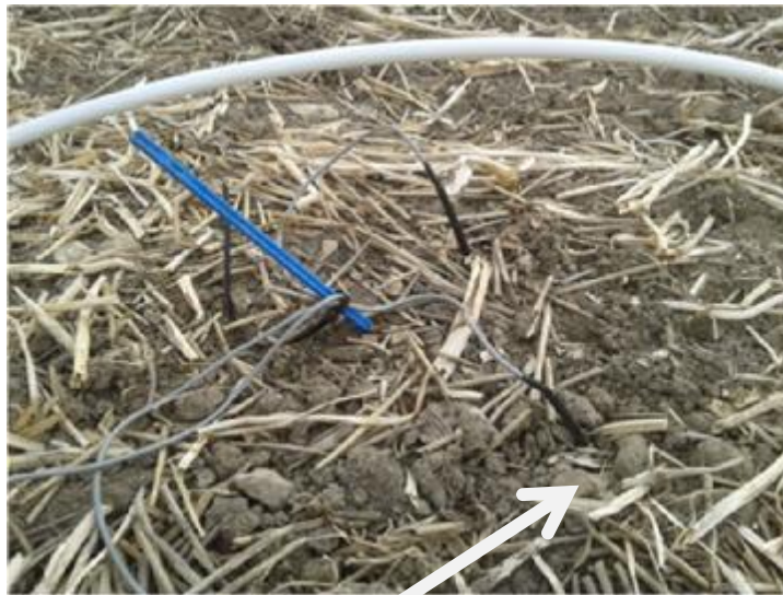
Strip Till, Sensor in der Saatreihe
