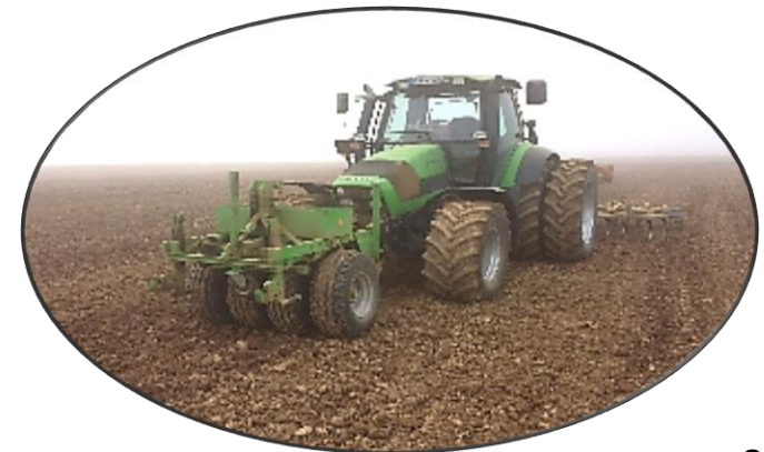
Flachgrubber mit Doppelstriegel, Schlepper mit Zwillingsbereifung und Frontreifenpacker
