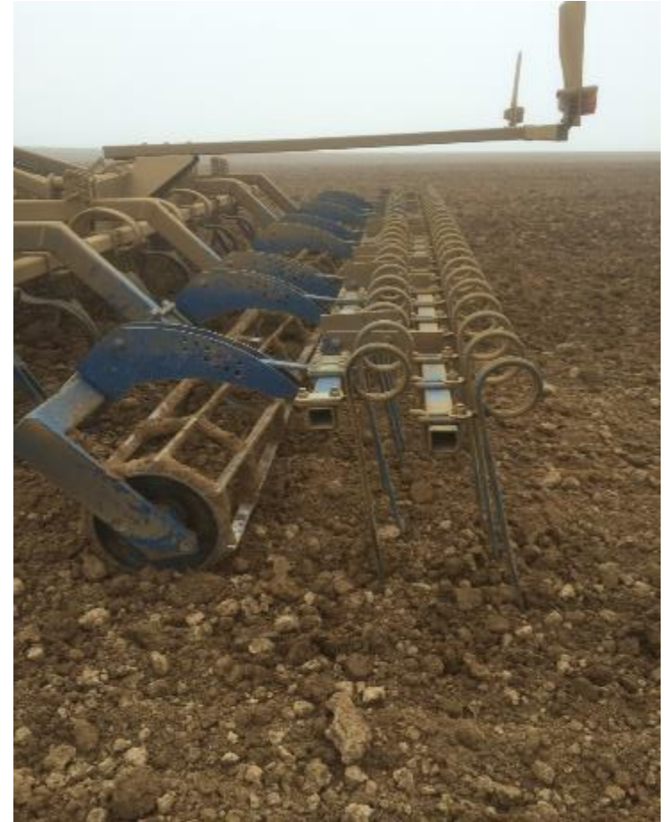
Doppelstriegel zur mechanischen Unkrautbekämpfung
