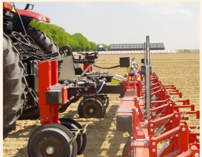
System mit Spurrädern und stabilem Parallelogramm zur hydraulischen Querverschiebung (Foto: Steketee, Niederlande)
