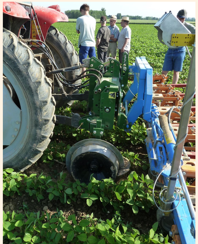
Garford-Querverschiebung mit Spurrädern. Rechts am Hackrahmen das Stativ mit der Kamerabox
