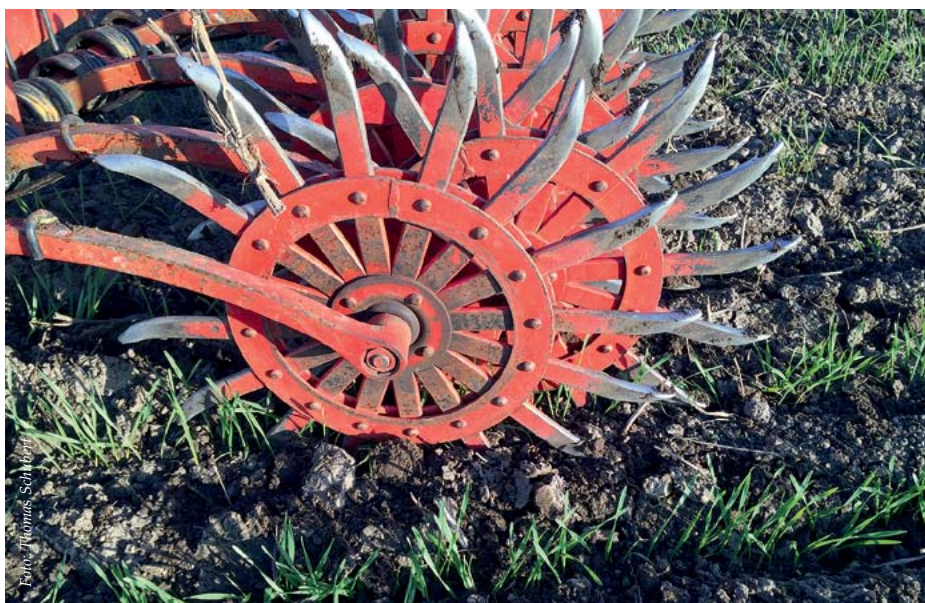
„Rotary Hoe“ von Yetter beim Einsatz im Winterweizen.
