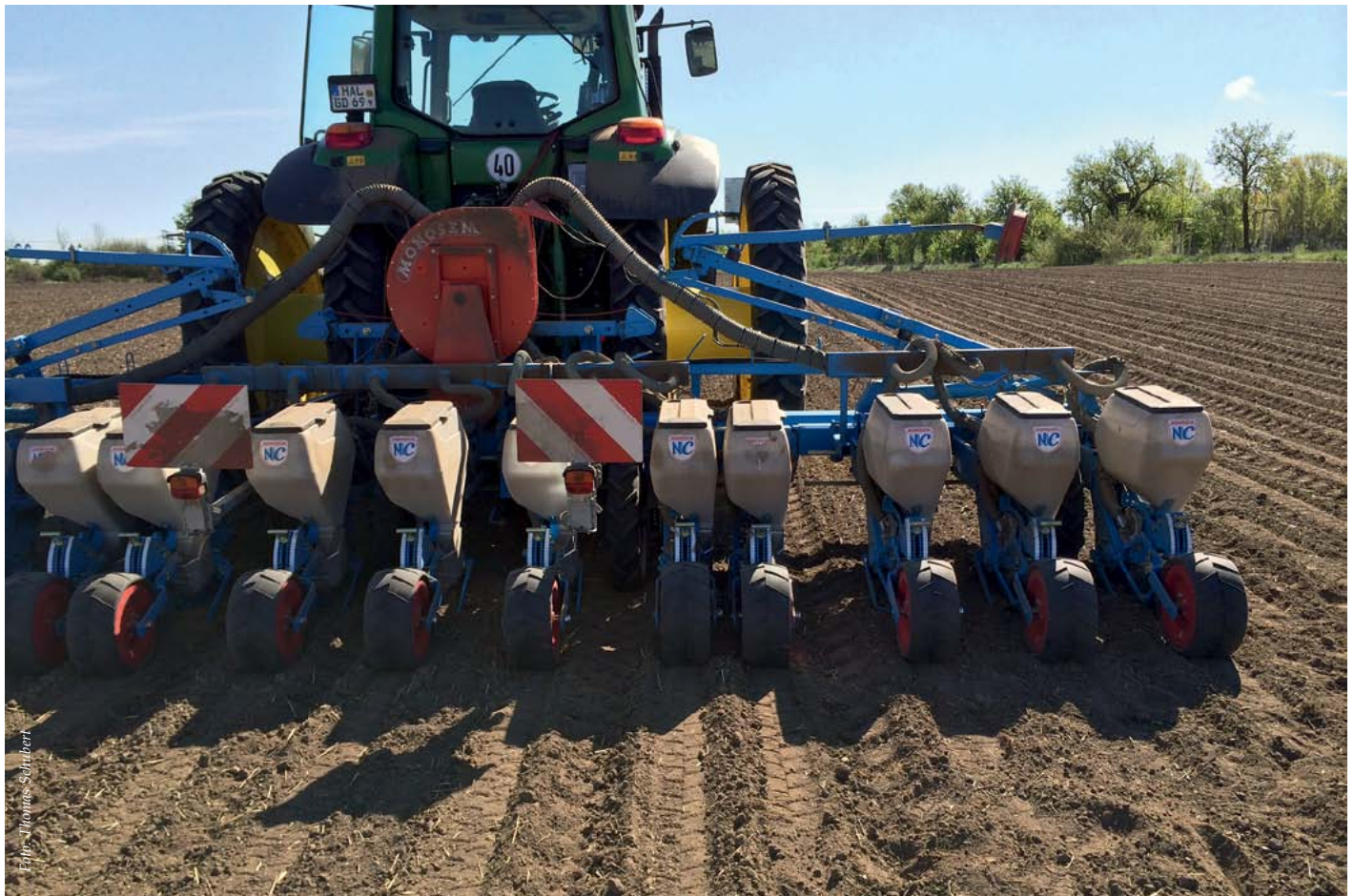
Aussaat von Sojabohnen mit einer Monosem-Einzelkornsämaschine mit Zwillings-Pflegevädern.
