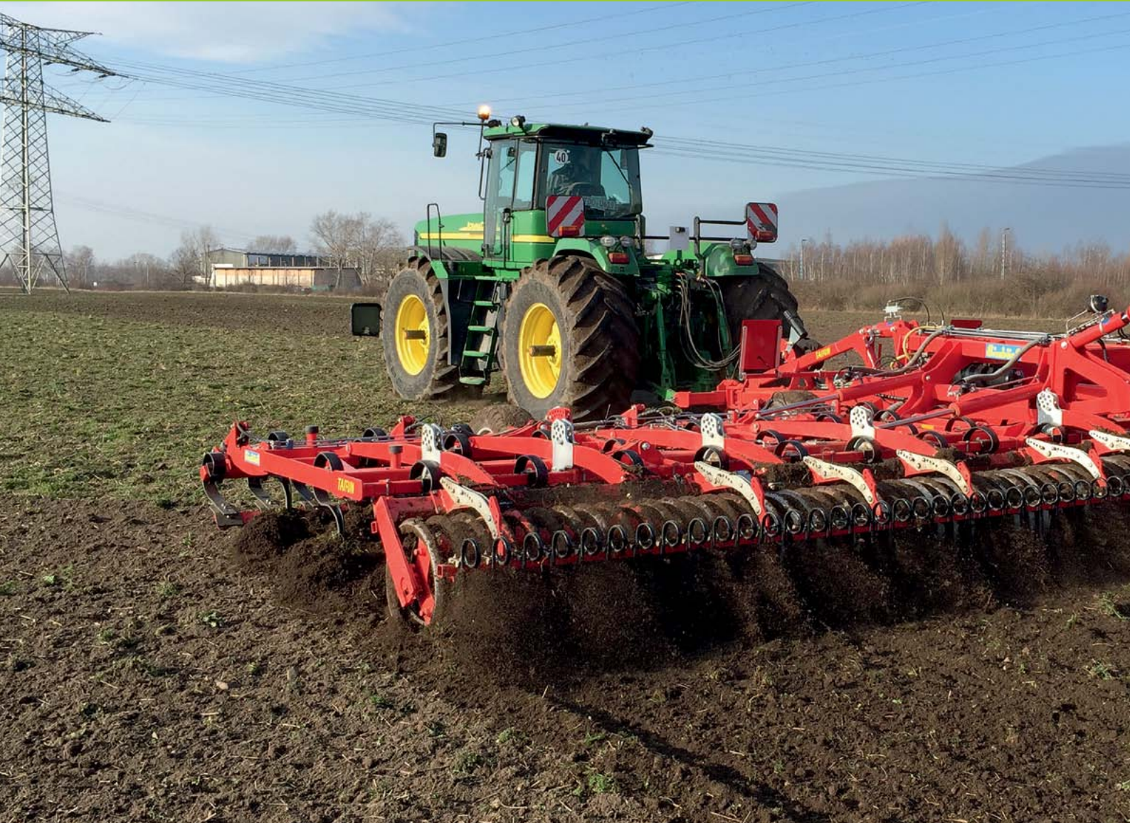
Einsatz eines Federzinken-Leichtgrubbers Einböck Taifun zur Unkrautbekämpfung und Saatbettbereitung.
