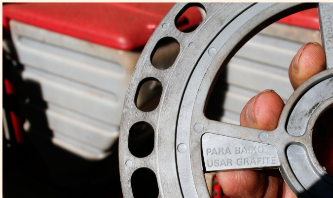
Säzscheibe mit dem Hinweis „Grafit verwenden“: In Brasilien geben die Saattechnikhersteller teilweise die Verwendung von Grafit vor, um den Verschleiß der (Kunststoff-) Bauteile in der Vereinzelung zu minimieren.
