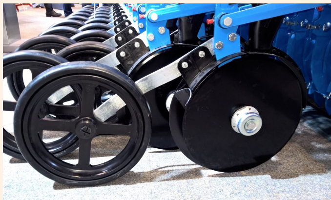
Optimales Drillsaat-Aggregat von Lemken mit Parallelogramm: Die große Andruckrolle läuft dicht hinter dem Säschar. Die Ablagetiefe richtet sich an der Andruckrolle aus, welche dicht hinter dem Schar läuft. Hier wird auch bei Unebenheiten die Saattiefe eingehalten. Das ganze Aggregat sitzt stabil an der Sämaschine
