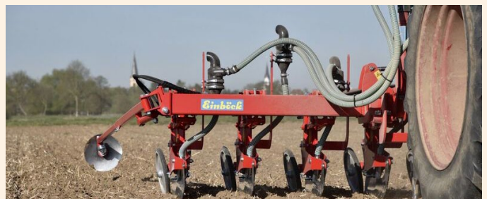
Einböck Chopstar Seeder: Der Fronttank kann auch für Untersaaten etc. eingesetzt werden; die robusten Säaggregate hängen an einem normalen Hackrahmen. Werksfoto
