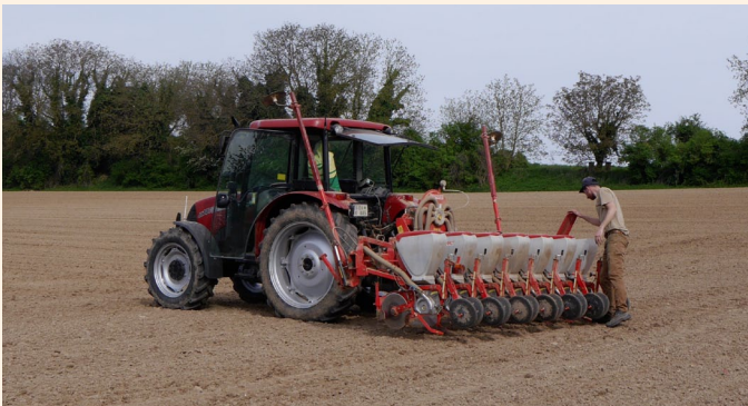
Mit dieser leichten, einfachen Gaspardo-Maschine werden jedes Jahr 50 Hektar Taifun-Soja im Breisgau gesät. Bei sorgfältiger Einstellung, gründlicher Saatbeetbereitung und geringem Tempo mit guten Ergebnissen.
