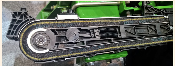
Joker bei sehr schneller Fahrt: Das Saatführungsrohr wurde bei der „Exact Emerge“ durch einen Bürstenkanal ersetzt, um die Position der Samen bis zum Boden zu kontrollieren.
