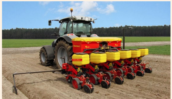
MaterMacc bietet Maschinen mit einem großen Düngerbehälter, der sich zusätzlich zum 70-Liter Saattank zum zentralen Saatgutbehälter umbauen lässt. Werksfoto
