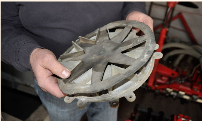
Einfacher Trick mit großer Wirkung: Selbst gebastelter Gummi-Prallschutz für den Verteiler bei pneumatischer Drillsaat.
