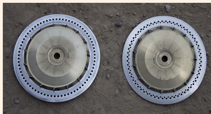
Welche Lochscheibe ist die Richtige? Eine Trockenübung im Winter schützt vor Überraschungen bei der ersten Aussaat! Das Zusammenspiel von Korngröße, Übersetzung, Lochscheibe und Vakuum muss passen.
