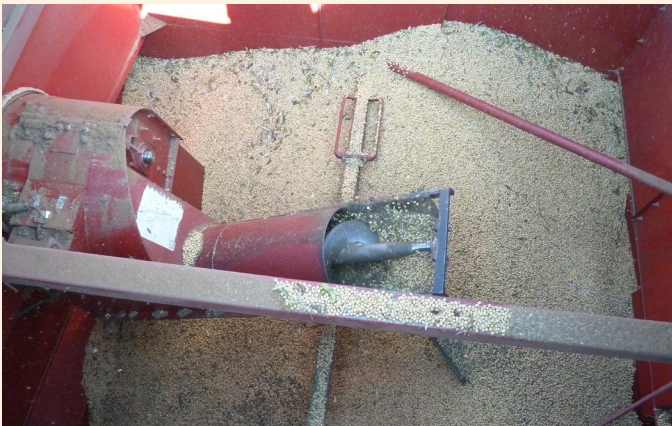
Wird der Korntank zu voll gemacht, kommt es zu Reibung und Bruch an der Förderschnecke
