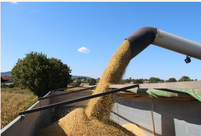
Beim Abtanken sollte die Schnecke auf Volllast laufen, um Bruch zu vermeiden. Den Tank lieber nicht ganz leer machen.
