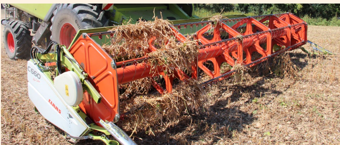
Vielfach ist das Sojastroh zur Ernte noch klamm und zäh. Breitere Querrohre schützen vor Wicklern.
