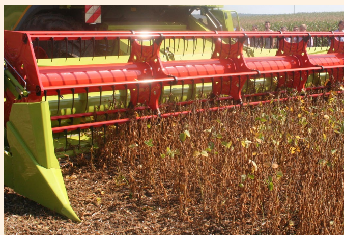
So tief wie möglich, so hoch wie nötig! Ein ebenes Saatbeet und keine aufliegenden Steine sind das A und O bei der Sojaernte. Flexschneidwerke rechnen sich bereits bei mittlerer Anbaufläche.
