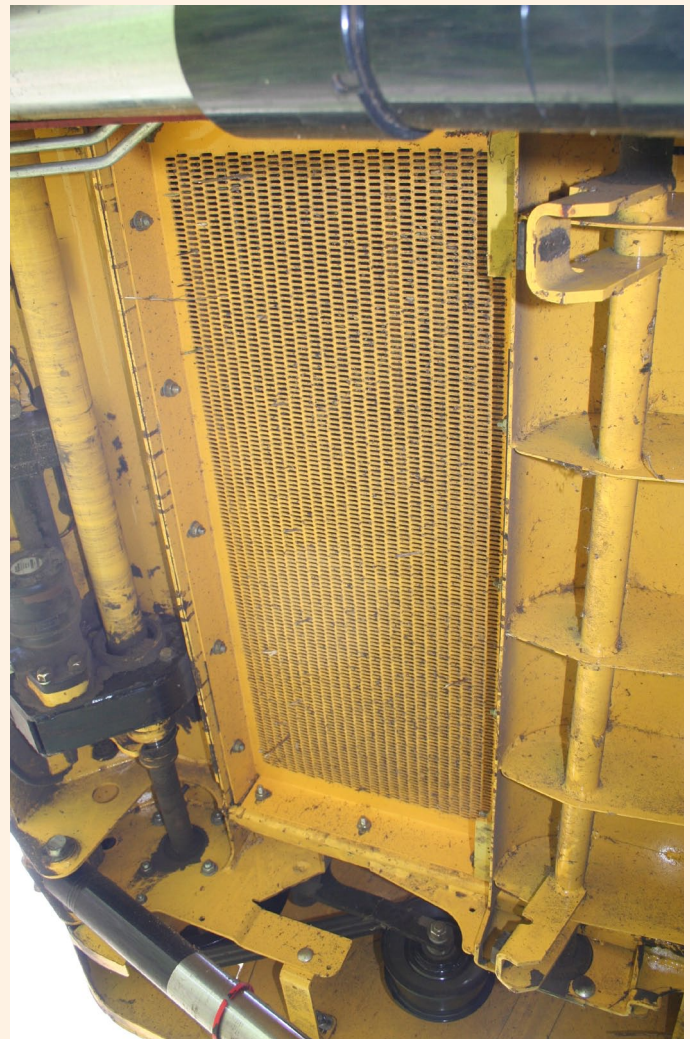
Durch ein Lochblech im Schrägförderer werden Unkrautsamen bereits abgeschieden, bevor sie mit dem Erntegut in Berührung kommen
