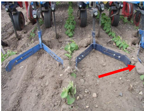
Abbildungen 21, 22: Flachhäufler können Steine an die Sojapflanzen schieben
