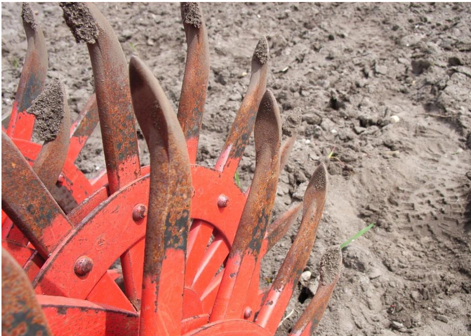
Abbildung 18: Löffelartige Zinken der Sternrollhacke
